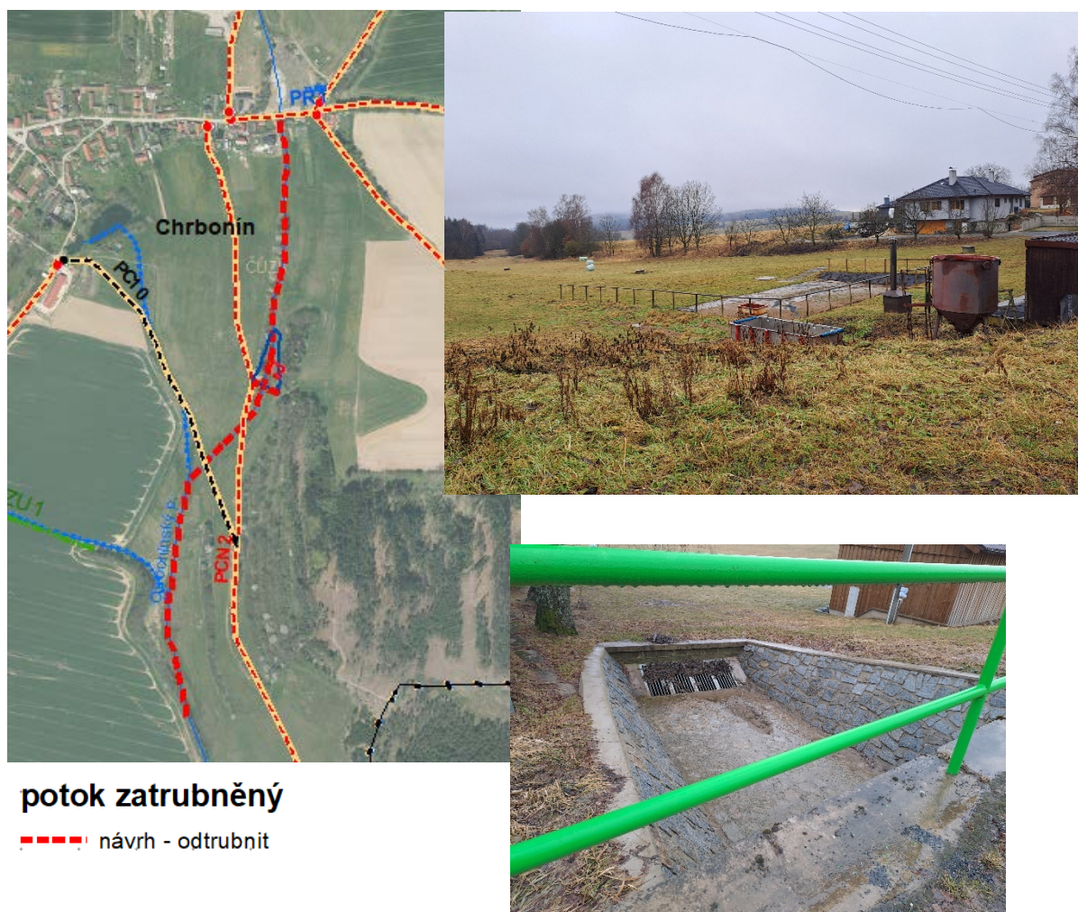
Obr. 44 Revitalizace toku – odtrubnění + foto
